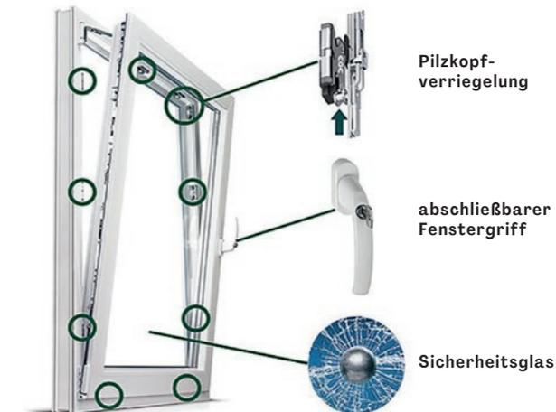
Pilzkopfverriegelung (im EG), abschließbare Griffe und 3fach Verglasung sind Möglichkeiten, die zusätzlichen Schutz für Ihr Zuhause bieten. Mit abschließbaren Griffen lassen sich alle beweglichen Schließelemente des Fensterbeschlages fixieren, sodass ein Aufhebeln von außen verhindert wird. Abschließbare Griffe können wir auf Wunsch gegen ein Angebot auch nachrüsten.
