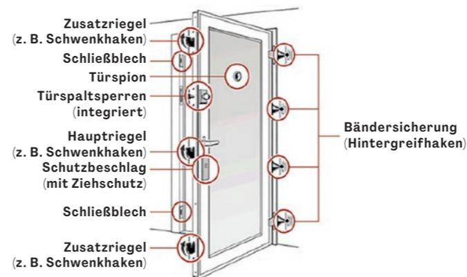
Jedes Sperrelement greift beim Verschließen der Tür in sein eigenes Schließteil. Die Tür wird somit an mehreren Punkten gleichzeitig gesichert. Das Aufbrechen von Türen wird dadurch wesentlich erschwert, was einen effektiven Schutz vor Einbrüchen bietet.
